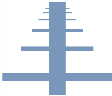
სურათი 27. ლოგო პერიოდული დიპოლების მასივიანი ანტენის გეომეტრია
